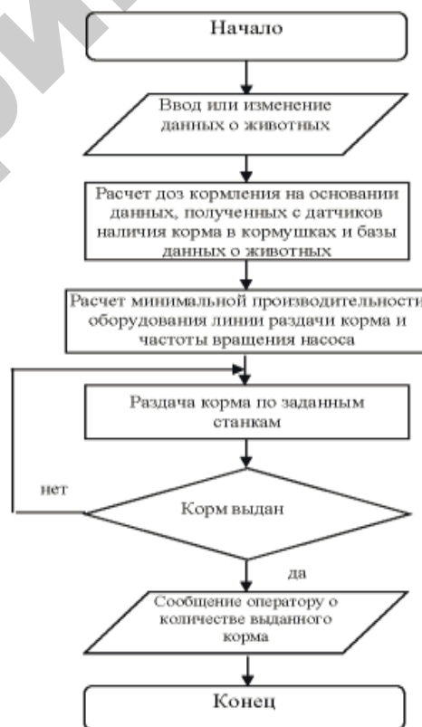
Рисунок 1. Блок-схема фрагмента алгоритма реализации энергосберегающей автоматизированной системы раздачи жидких кормов
