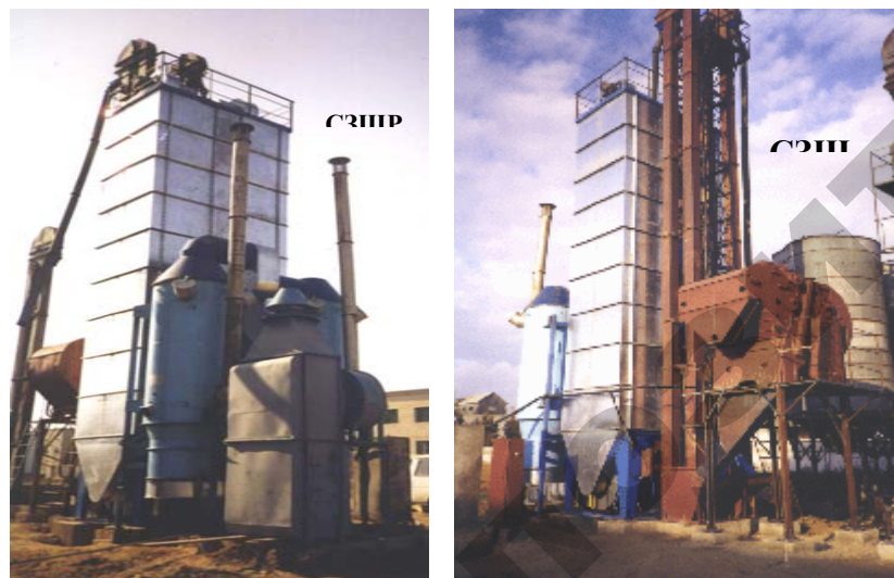
Рис. 2.5. Общий вид шахтных зерносушилок СЗШР-8 (на твердом топливе) и СЗШР-16 (на жидком топливе)
