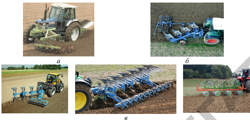
Рис. 1.2. Виды приставок и способы их установки на пахотных агрегатах: а – навешиваемые спереди трактора; б – прицепные; в – навешиваемые на раму плуга
