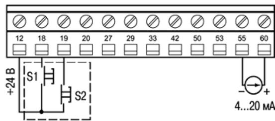
Рис. 5.10. Схема подключений конфигурации «Управление скоростью и инверсной характеристикой»
