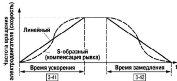
Рис. 5.6. Характеристики разгона/торможения
