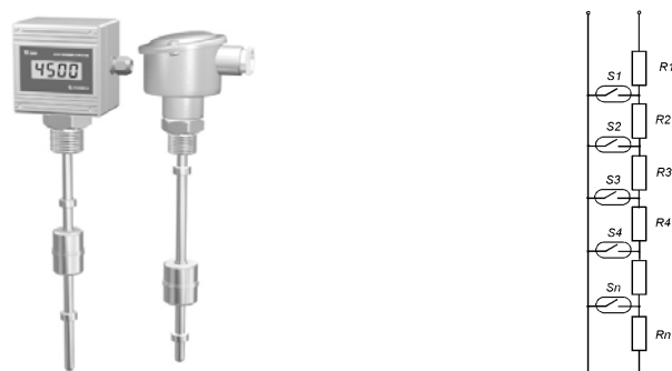
Рис. 14.3. Поплавковый уровнемер с резистивной матрицей и герконовыми реле
