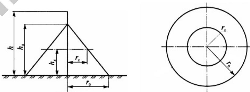
Рисунок 3.3 – Зона защиты одиночного стержневого молниеотвода
