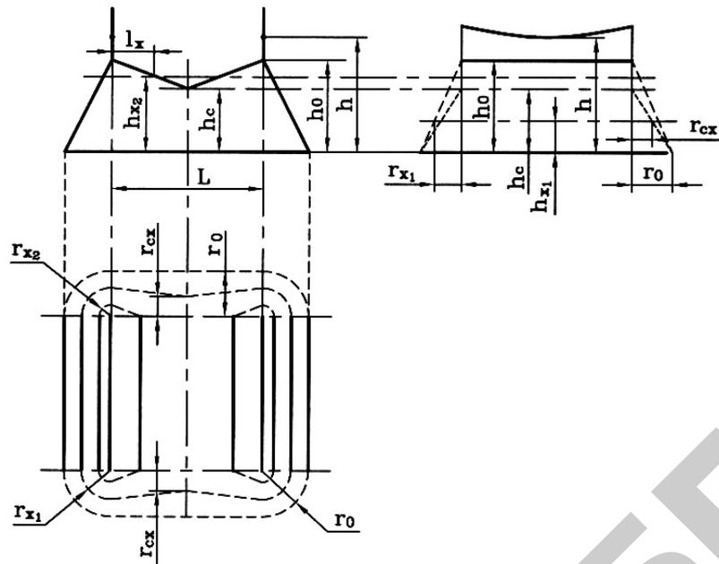
Рисунок 3.7 – Зона защиты двойного тросового молниеотвода
