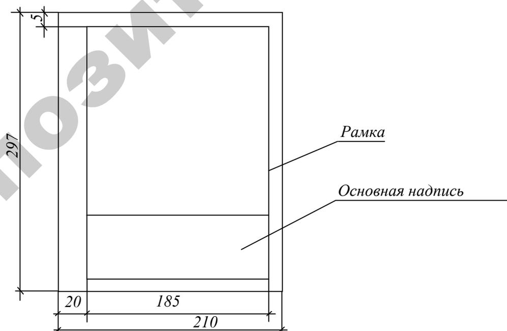
Рисунок 4.1 – Компоновка и размеры листа текстовой части ПЗ
