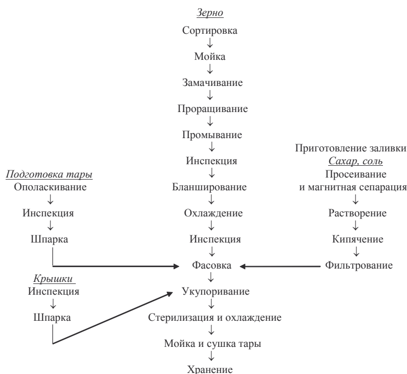
Рисунок 3. Технологическая схема производства консервированных продуктов из пророщенного зерна пшеницы и тритикале
