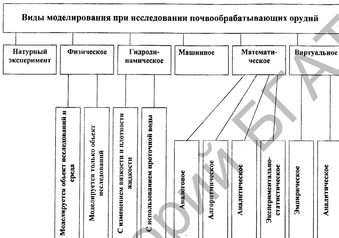
Рисунок 1 - Виды моделирования при исследовании почвообрабатывающих орудий
