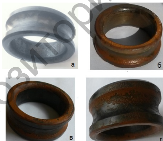
Рисунок 1 – Фотографии образцов внутреннего кольца подшипника, обработанного методом MAO и подвергнутый испытанию через определенное время:
