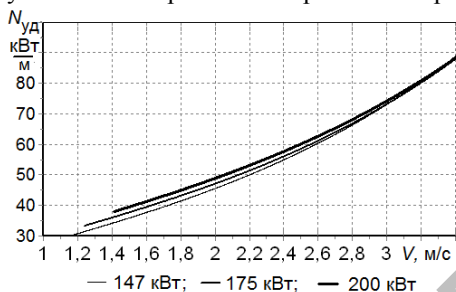
Рисунок 2 - Зависимость удельных затрат мощности трактора «Беларус 2022» при вспашке почвы плугом с комбинированными рабочими органами от скорости движения
