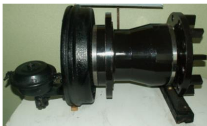
Рисунок 1 Опорно-сцепное устройство для сдваивания задних колес
