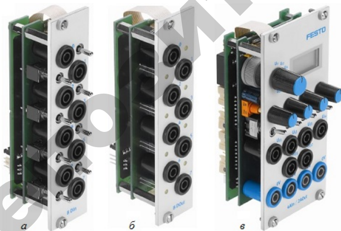
Рис. 6. Модули ввода/вывода цифровых и аналоговых сигналов
