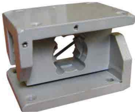
Рисунок 2. Упругий элемент динамометра на малые усилия
