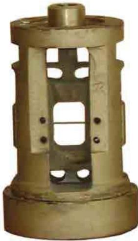
Рисунок 1. Упругий элемент динамометра стержневого типа
