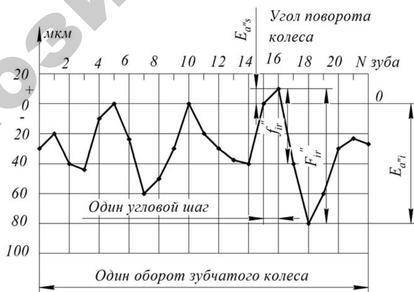
Рис. 6.3.1. График изменения измерительного межосевого расстояния
