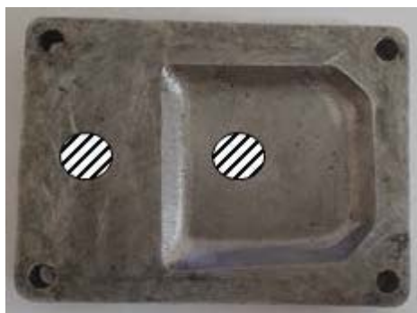
Рисунок 5. Крышка топливного насоса (участки нанесенного загрязнения обозначены белыми заштрихованными кружками)
