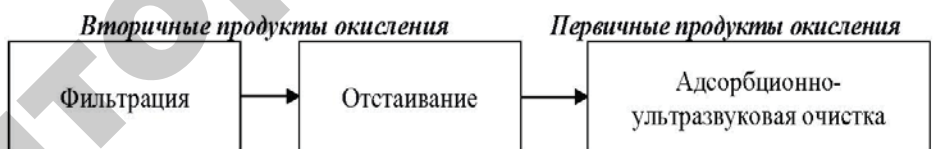
Рисунок 2. Схема очистки нерафинированного масла от первичных и вторичных продуктов окисления
