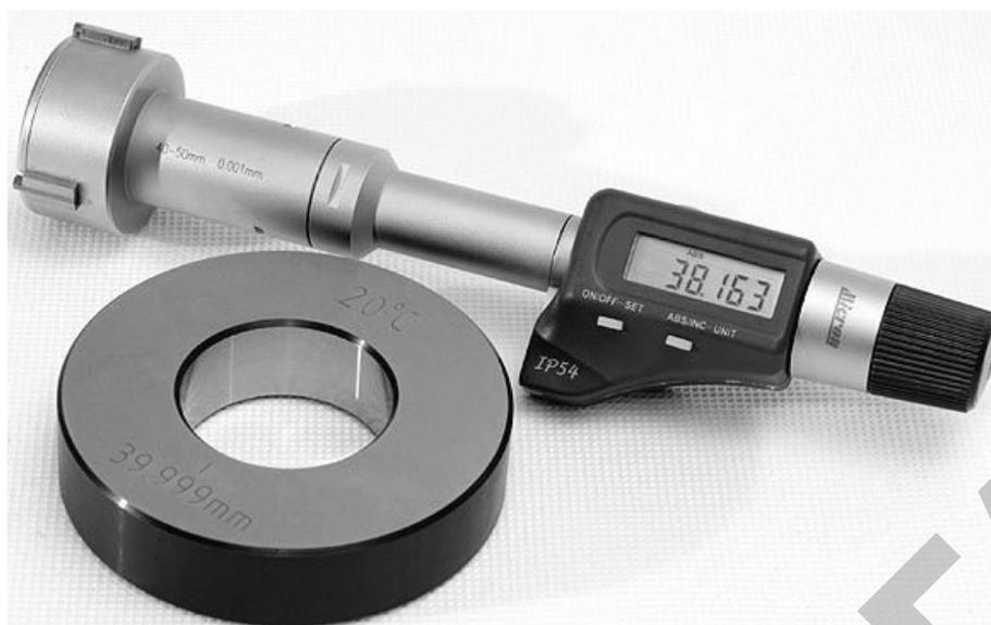
Рис. 1.2.42. Нутромер трехточечный типа НМТЦ
