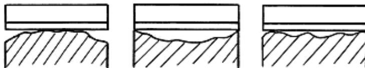
Рис. 2.2.1.1. Контроль прямолинейности лекальной линейкой
