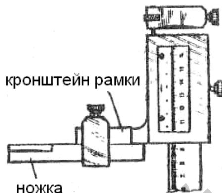
Рис. 1.2.19. Расположение ножки в держателе
