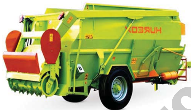
Рис.1. Измельчитель-смеситель-раздатчик кормов с наличием загрузочной фрезы ИСРК-12Ф
