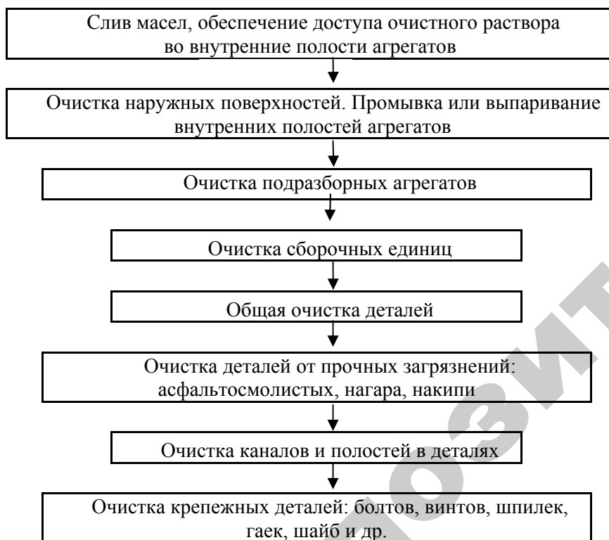
Рис. 4.2. Последовательность операций очистки поверхностей детали от эксплуатационных загрязнений
