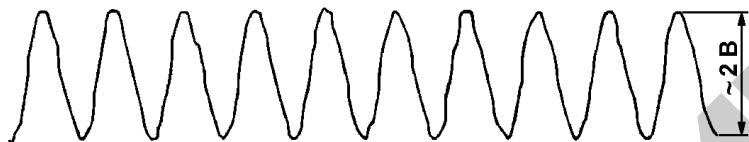
Рис. 2.16. Вид осциллограммы, характеризующий сигнал работающего дозатора
