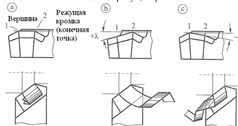
Рис. 1.6. Влияние угла наклона главной режущей кромки на направление схода стружки
