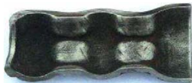
Рис. 2 - Отпечаток проволочной оплетки на внутренней поверхности
