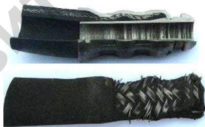
Рис. 1 - Вид шланга под обжимной втулкой
