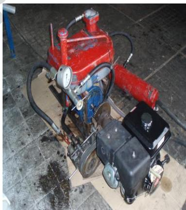
Рис. 2 – Экспериментальный образец обкаточно-тормозного стенда для двигателей мощностью до 10 кВт
