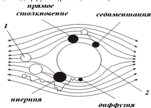
Рис. 1. Механизмы осаждения частиц загрязнений; 1 – частица; 2 – коллектор (волокно)
