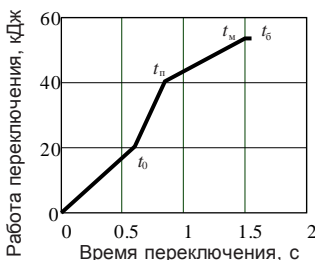
Рис. 3 – Расчетные значения работы переключения ВОМ
