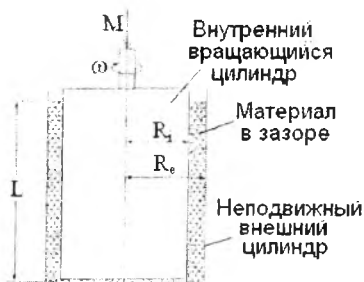
Рис. 5. Схема ротационного вискозиметра с вращающимися цилиндрами
