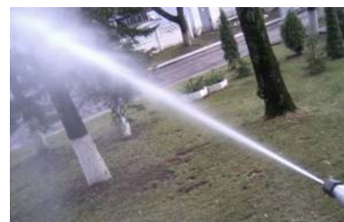
Рис. 2. Форма струи с минимальным углом распыления ( d_{\text{н}}=1,8\text{мм} , p \geq 12\text{МПа} )
