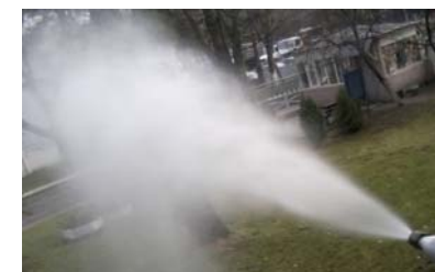
Рис. 3. Форма струи с максимальным углом распыления ( d_{\text{н}}=1,8\text{мм} , p \geq 12\text{МПа} )
