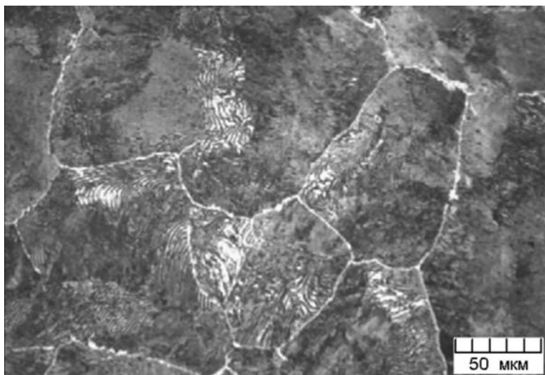
Рис. 2.9. Микроструктура заэвтектоидной стали У10 с содержанием углерода 1,0% после нормализации. Перлит пластинчатый и цементит вторичный в виде тонкой сетки
