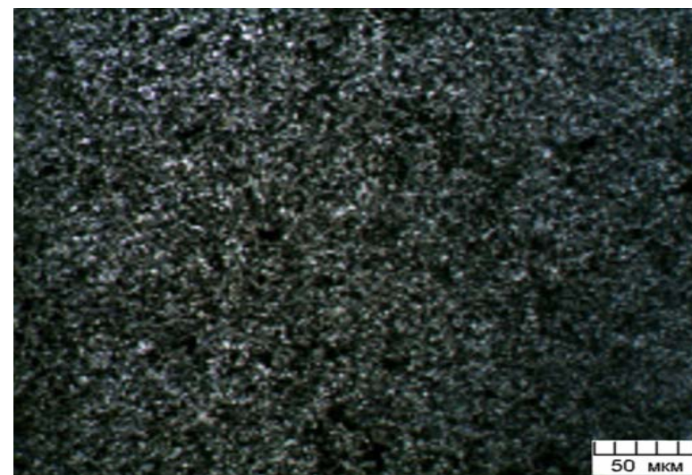
Рис. 2.8. Микроструктура эвтектоидной стали У8 с содержанием углерода 0,8 % после отжига. Структура – зернистый перлит
