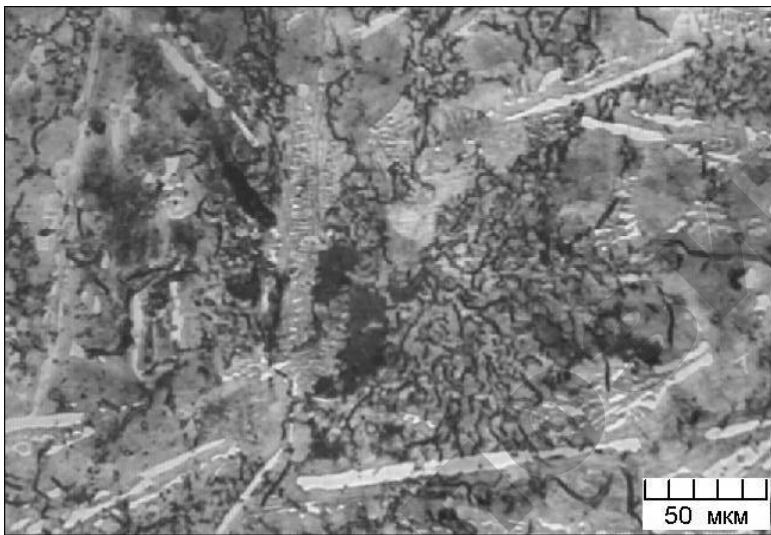
Рис. 3.7. Микроструктура половинчатого чугуна после травления. Графит – черные пластинки, перлит и цементит (белые пластинки)
