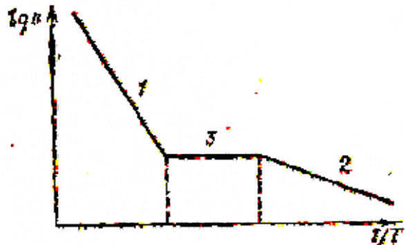
Рис. 2.3. Зависимость концентрации носителей заряда в полупроводнике от температуры: 1 – область собственной электропроводности; 2 – область примесной электропроводности; 3 – область полной ионизации примесей
