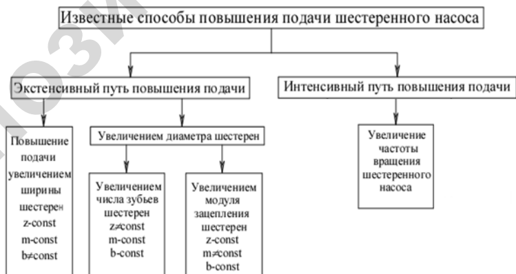
Рисунок 1 — Классификация известных способов повышения подачи шестеренного насоса
