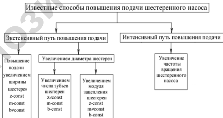
Рисунок 1 — Классификация известных способов повышения подачи шестеренного насоса
