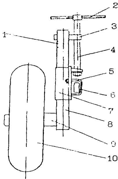
Рис. 4.3. Колесо с механизмом регулирования глубины обработки:
