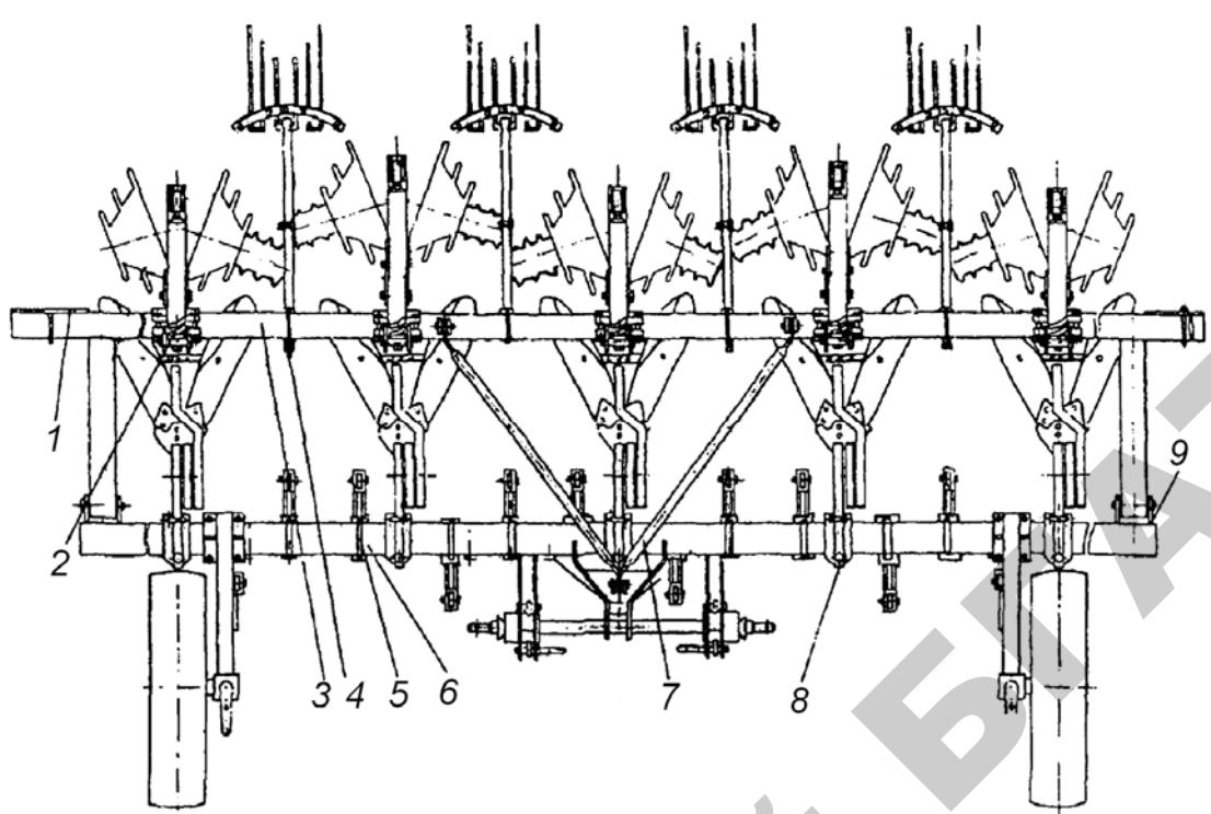
*Рис. 5.25. Культиватор-окучник-гребнеобразователь ОКГ-4 (вид сверху):
