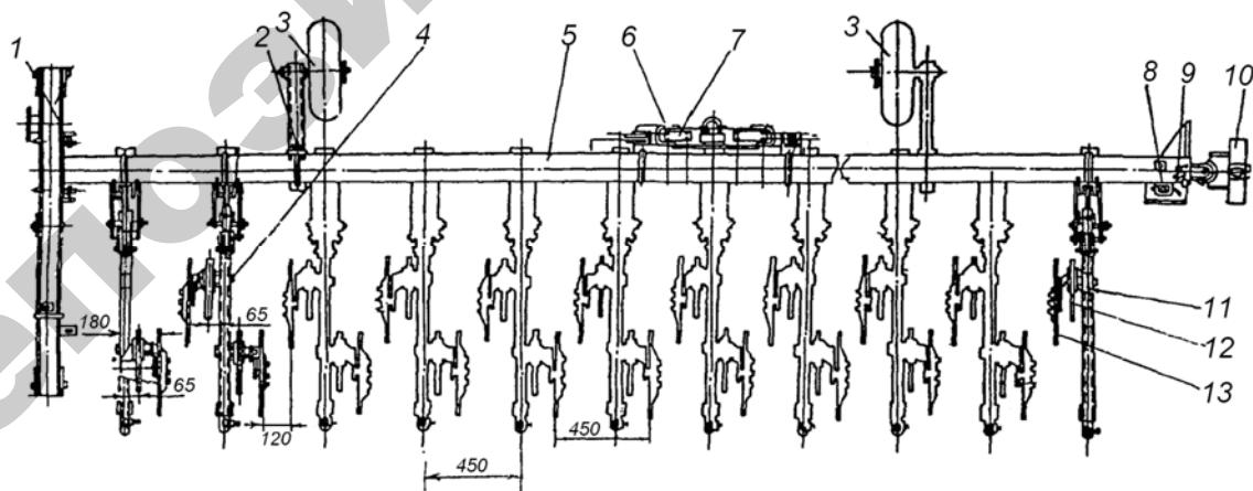
Рис. 5.15. Культиватор для междурядной обработки почвы КМС-5,4-01 (вид сверху):
