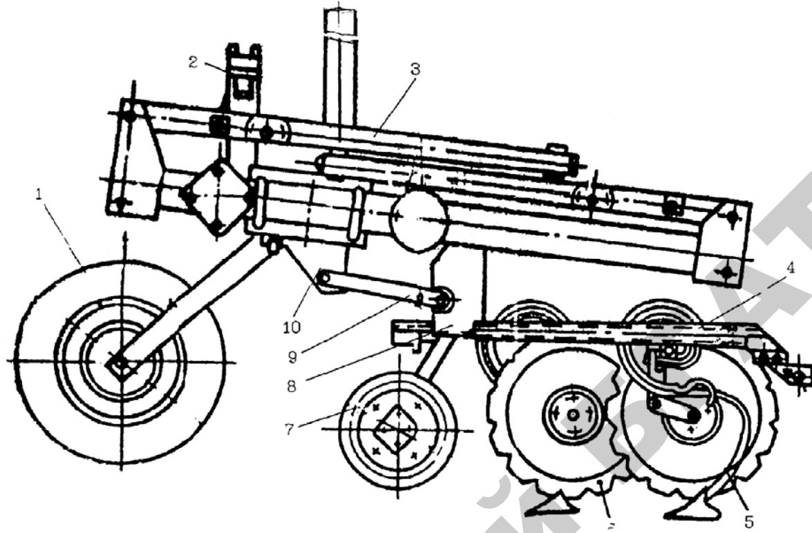
*Рис. 5.16.* Культиватор для междурядной обработки почвы КМС-5,4-01 (вид сбоку):
