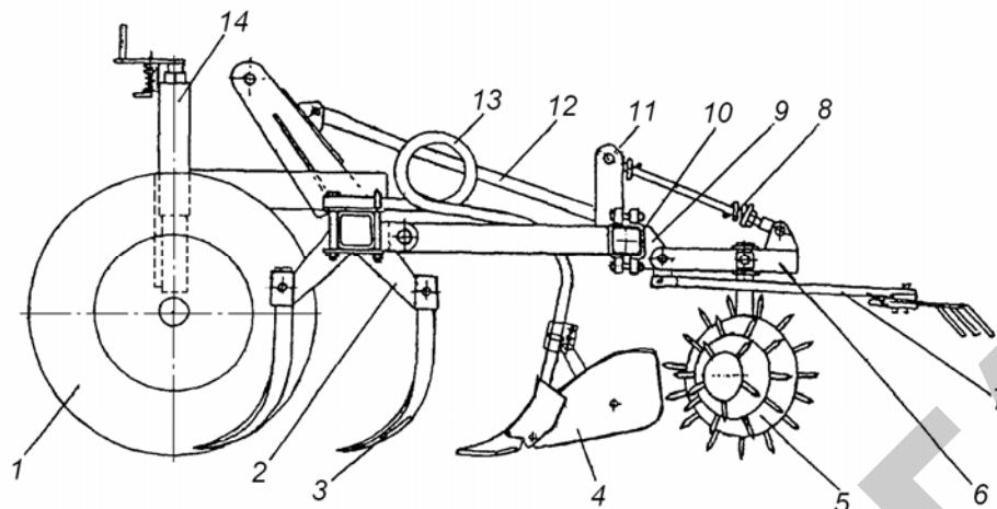
*Рис. 5.26. Культиватор-окучник-гребнеобразователь ОКГ-4 (вид сбоку):*
