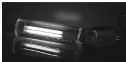
Рис. 2.53. Брелок с радиолуминесцентной (тригневой) подсветкой
