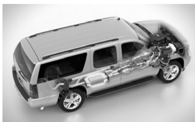
Рис. 2.19. Автомобиль с интегрированным в выхлопную систему термоэлектрогенератором
