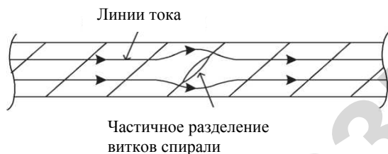
Рис. 5.4. Схема прохождения тока по спирали при частичном разделении ее витков
