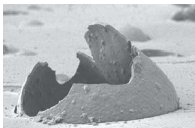
Рис. 5.8. Разорванная микрокапсула, встроенная в полимерную матрицу (диаметр микрокапсулы 100 мкм)
