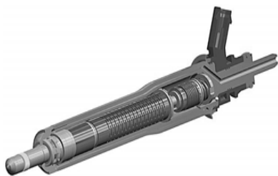
Рис. 1.13. Пьезофорсунка для впрыска бензина: подача электрического напряжения вызывает расширение пьезокерамического столба, который приподнимает дозирующую иглу
