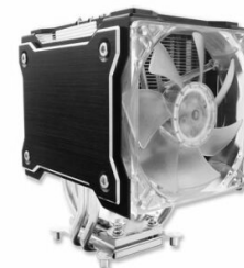
Рис. 2.20. Кулер с элементом Пельтье для процессора
