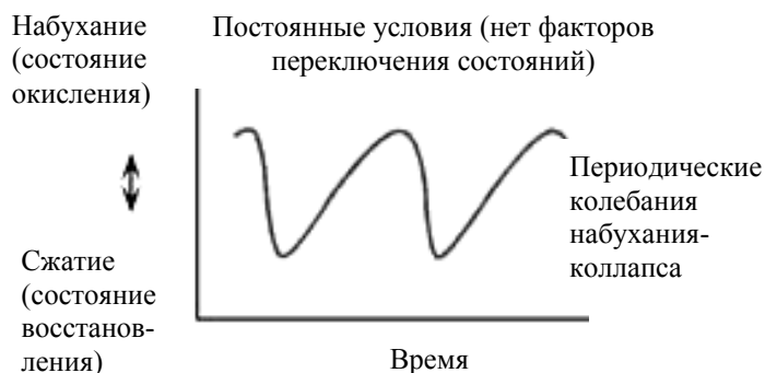
Рис. 1.26. Периодические колебания набухания – коллапса в геле
