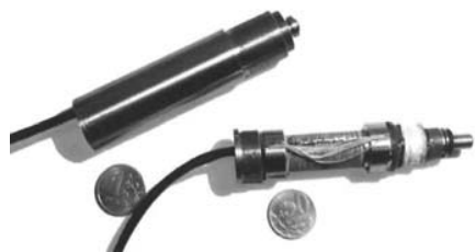
Рис. 1.11. Пьезодвигатель с встроенным индуктивным датчиком микроперемещений
