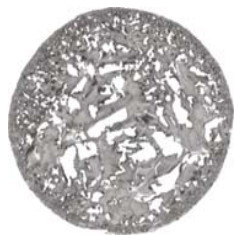
Рис. 1.56. Структура «магнитной губки»
