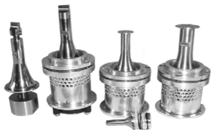
Рис. 1.15. Ультразвуковые колебательные системы на основе пьезокерамических преобразователей для воздействия на жидкие среды
