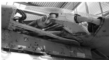
Рис. 1.60. Механизм, изменяющий стреловидность крыла истребителя МиГ-23
