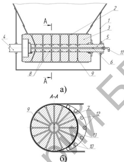
Рисунок 1 — Приводной барабан ленточного транспортера
