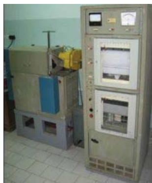
а) б) Рисунок 1. Испытательная машина трения 2070 СМТ-1: а – машина трения; б – рабочая зона машины трения
