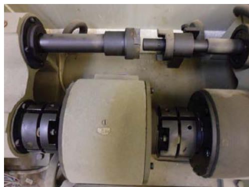
а) б) Рисунок 1. Испытательная машина трения 2070 СМТ-1: а – машина трения; б – рабочая зона машины трения
