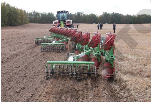
Рисунок 3. Испытания опытного образца плуга ПО-(8+4)-40: а – в заводских условиях; б – в полевых условиях
