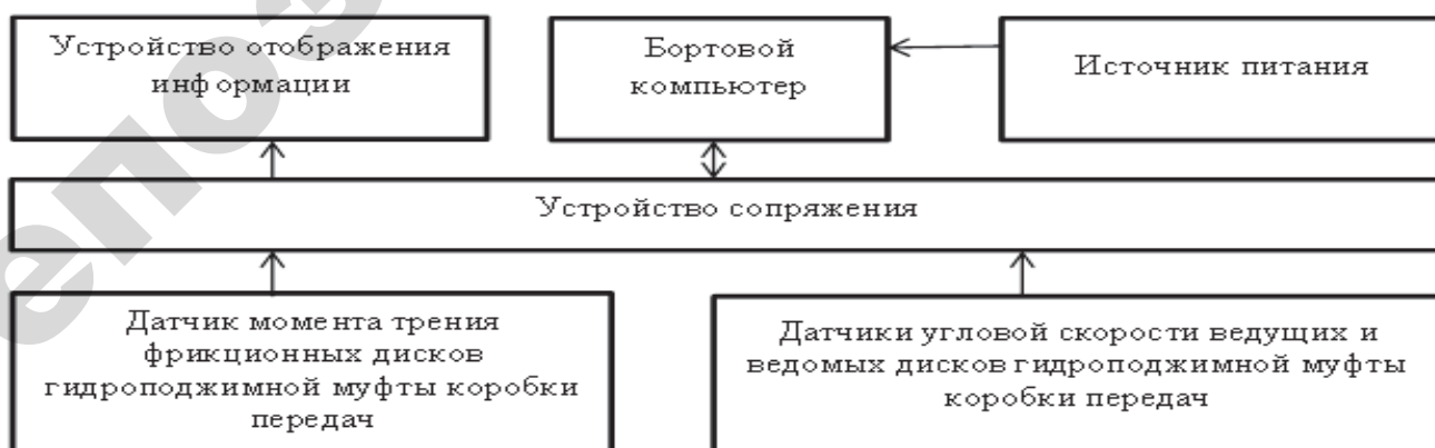
Рис. 1. Структурная схема системы бортового диагностирования степени износа фрикционных дисков гидроподжимных муфт коробки передач
