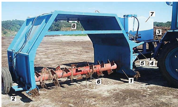
Рис 1. Общий вид аэратора навозо-компостных буртов: 1 – рама; 2 – опорные колеса; 3 – прицепное устройство; 4 – карданный вал; 5 – редуктор; 6 – барабанно-лопастный рабочий орган; 7 – емкость для воды; 8 – распылители
