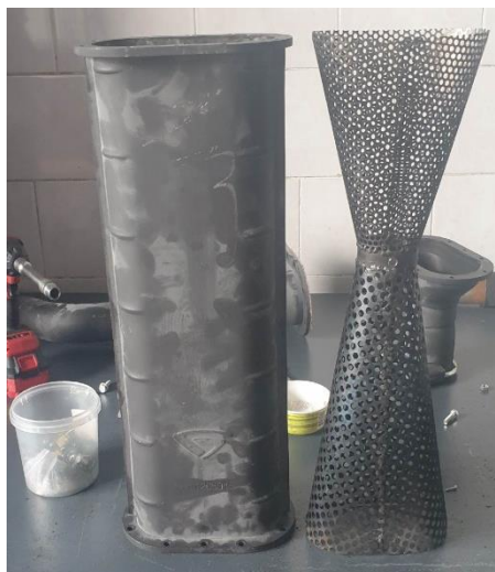
Рисунок 4 – Экспериментальный глушитель 800-1205100 в разборе
