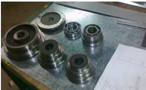
Рисунок 5 – Оправки для диагностирования различных типоразмеров подшипников качения
