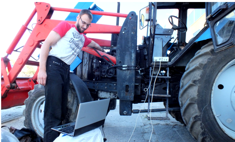
Рисунок 3 – Инженер Кирдищев Д.В. производит измерение вибрации на форсунках дизельного двигателя Д-243
