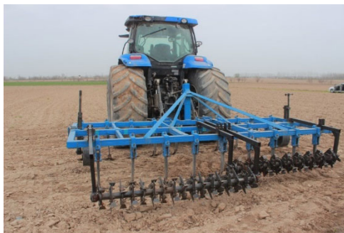
Рисунок 1. Роторные умягчители, оснащенные Г-образными и лопастными лопастями
