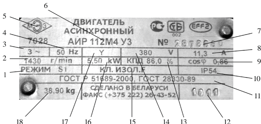
Рис. 3.2. Заводской щиток асинхронного электродвигателя серии АИР:
