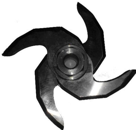
Рисунок 2 – Фотография головки куттера с ножами, режущая кромка которых выполнена в виде ломаной линии, построенной по закону логарифмической спирали
