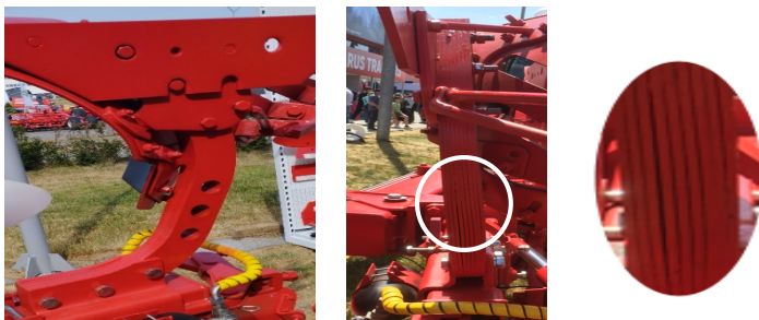
Рисунок 1 – Грядиль плуга с модифицированной конструкцией, изготовленный с использованием SL-технологии (БГАТУ/МЗШ)
