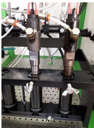
Рисунок 4 – Исследуемые форсунки CRIN2 (слева – новая форсунка, справа – форсунка со следами изнашивания), установленные на стенде для проведения исследований виброакустических характеристик
