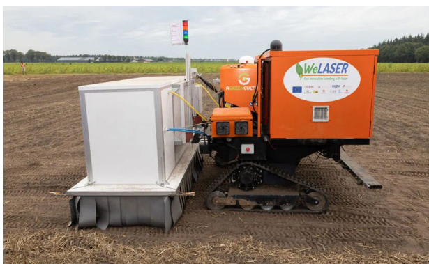
Рисунок 1 – Автономный роботизированный робот Agreenculture CEOL на гусеничном ходу
