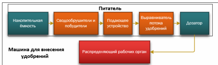
Рисунок 1 – Позэлементная схема машины для внесения удобрений
