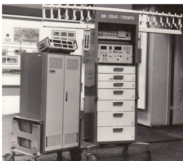
Рисунок 1 - Диагностическая измерительно-прогнозирующая система (ДИПС) КИ-13940-ГОСНИТИ на основе электронного измерительного комплекса К-736 Ленинградского института ВНИИЭП (разработка выполнена ВНИИЭП совместно с ГОСНИТИ, ЛСХИ, УкрГОСНИТИ и Киевским СКБ им. Ястребова)
