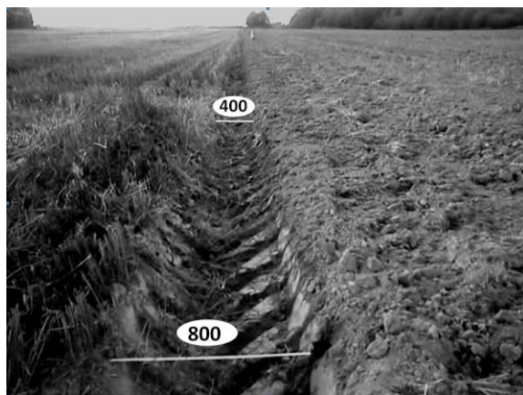
Рисунок 2 – Ширина борозды по следу заднего колеса с шириной шины 730 мм. (МТЗ-3522 +ППО-8-40, СПК «Овсянка» Горьковского района, 25.08.2013)
