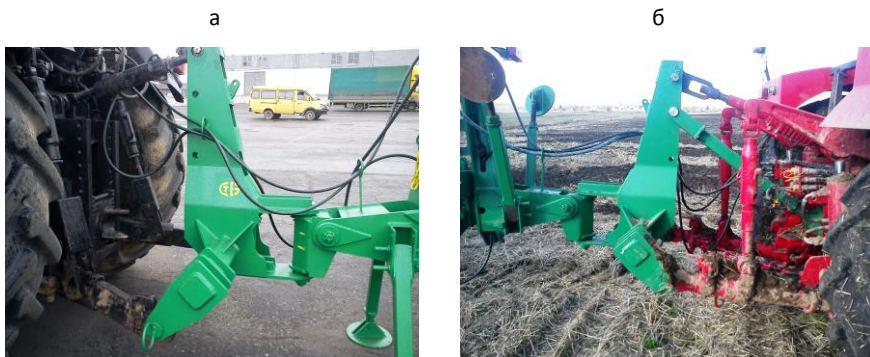
Рисунок 11 – Схема соединения навески тракторов: МТЗ-3522 и плуга по кат. 4 (НУ-4) (а), К-744Р2 и плуга по категории «Кировец» (б)
