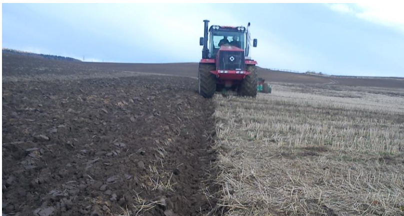
Рисунок 12 – Слитная и равноглубинная пахота плугом ППО-9-45+1-30 при вождении трактора К-744 Р2 правым (или левым) бортом в полуборозде (1-ая Минская птицефабрика, 16 апреля 2014 год)
