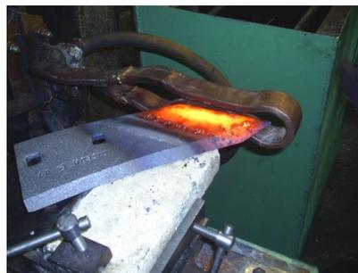
Рисунок 2 - Процесс индукционной наплавки на РОПМ:
