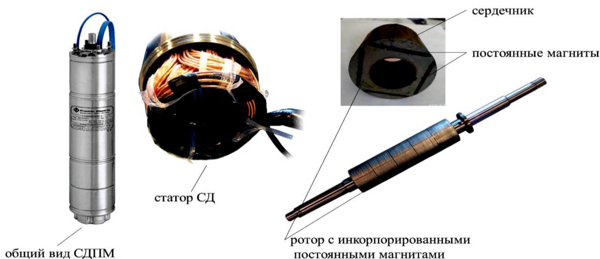
Рисунок 4. Погружной СДПМ герметичного исполнения
